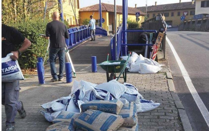
Le prove di carico realizzate sul ponte pedonale sopra l'Addetta
